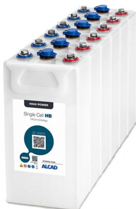
Батареи рекомендуется применять в решениях, где необходимы длительные разряды (от 3 часов). В таких решениях как резервное электроснабжение, телекоммуникации, накопление энергии. Для обеспечения таких свойств при производстве используются наиболее толстые пластины. В эксплуатации токи, как правило, невелики относительно емкости и разряды нечастые.
