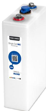
Линейка одноэлементных никель-кадмиевых аккумуляторов MC / MB разработана для применений, в которых обычно требуется, батарейная поддержка электрической нагрузки в течение от 30 минут до 3 часов, или для «смешанных» нагрузок, сочетающих высокую и низкую скорости разряда.
