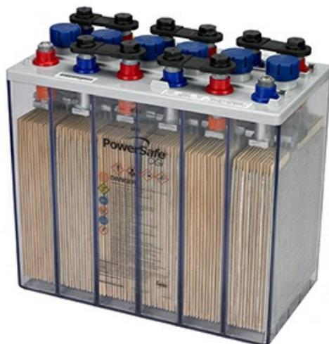
**EnerSys PowerSafe 6 OGi 80** - свинцово-кислотные малообслуживаемые батареи с жидким электролитом. Технология VLA идеально подходит для приложений на рынке коммунальных услуг. Состав стержневой пластины OGi обеспечивает конструкцию с высокой плотностью энергии, компактные размеры и долгий срок службы. Решетка из сплава с низким содержанием сурьмы снижает потребление воды и впоследствии снижает затраты на обслуживание.
