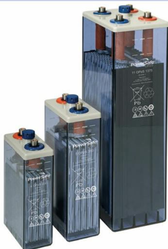
**EnerSys PowerSafe 13 OPzS 1625** - классическая свинцово-кислотная малообслуживаемая (долив воды требуется примерно один раз в три года) аккумуляторная батарея. Конструкция предусматривает увеличенную по сравнению с требованиями стандарта DIN емкость. Благодаря трубчатым пластинам, батареи EnerSys PowerSafe 13 OPzS 1625 демонстрируют прекрасную производительность и продолжительный срок службы как в буферных, так и в циклических режимах.
