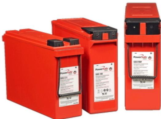
**EnerSys PowerSafe SBS 100F** - свинцово-кислотные необслуживаемые AGM аккумуляторные батареи с фронтальным расположением терминалов для размещения в телекоммуникационных шкафах и стойках. Технология тонких пластин из чистого свинца (TPPL) обеспечивает длительный срок службы, высокую плотность энергии и превосходный срок хранения.
